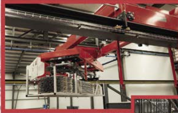
ALBATROS Sistema logístico aéreo en interfaz con almacén automático y AGVs
