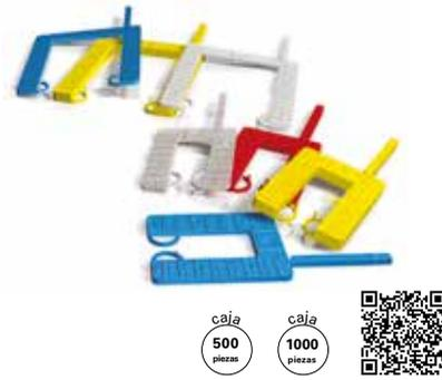
Las cuñas de montaje son piezas de plástico provistas de una barra de montaje, diseñadas especialmente para proporcionar una sincronización en el montaje lateral y vertical en el emplazamiento de carpinterías y pre-marcos. Estas cuñas disponen de muescas en ambos lados para evitar el deslizamiento. Se utilizan para la instalación de pre-marcos metálicos y de madera, carpinterías de madera, de aluminio y PVC. Permiten la instalación posterior de embellecedores, molduras, etc...
