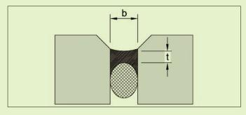
El diseño de las juntas de la pared exterior. deben ser de conformidad entre el ancho de la junta y la superficie de los componentes en el área de la junta.
